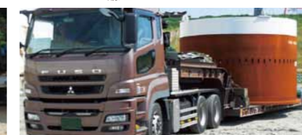
アンカーリング輸送
